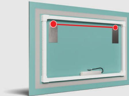
2. Markieren Sie anhand der durchgeführten Messungen zwei Punkte an der Wand, die zum Bohren von Löchern verwendet werden. Vergewissern Sie sich, dass die Abstände zwischen den Spiegelaufhängern/Löchern und den an der Wand markierten Punkten gleich sind.
